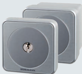
钥匙开关, 标配 3 把钥匙 脉冲式 • 通过内部的按键设置，可以实现旋转 钥匙后常开触点一直保持闭合的状态 • 防护等级 IP 65 STUP50（嵌入式） 尺寸 (W x H x D) : 80 x 80 x 15 mm 嵌入连接盒: 直径 \phi 60 mm，深 55 mm STAP50（外装式） 尺寸 (W x H x D) : 80 x 80 x 65 mm
