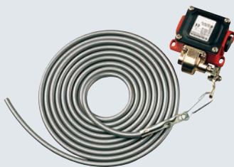
拉绳开关 可以水平或垂直安装，铸铝壳体，防护等级 IP 65，拉绳长度为 4 m
