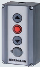
按钮开关 DTH RM 独立的开/停/关按键 带迷你锁：用于锁闭开关键功能，防止无关人员开启大门（配 2 把钥匙） 防护等级: IP 65 尺寸: 90 × 160 × 55 mm (W × H × D)
