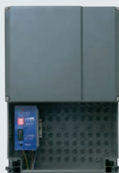
地磁感应器 DI 2 带独立箱体 适用于双线圈 感应器带两个常开触点 可以设置为脉冲或常闭触点 可实现方向识别 箱体尺寸: 202 x 164 x 130 mm (W x H x D) 切换能力: DI 2: 250 V AC, 4 A, 1000 VA, (电阻型 AC) 含线圈铜线
