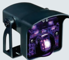
雷达/红外感应器 通过雷达感应物体的移动，通过红外感应物体的存在，从而快速准确的实现自动开门，可靠的保护功能，最大安装高度为 6 m。 在潮湿环境以及室外环境，仅雷达功能起作用。 壳体防护等级：IP 65
